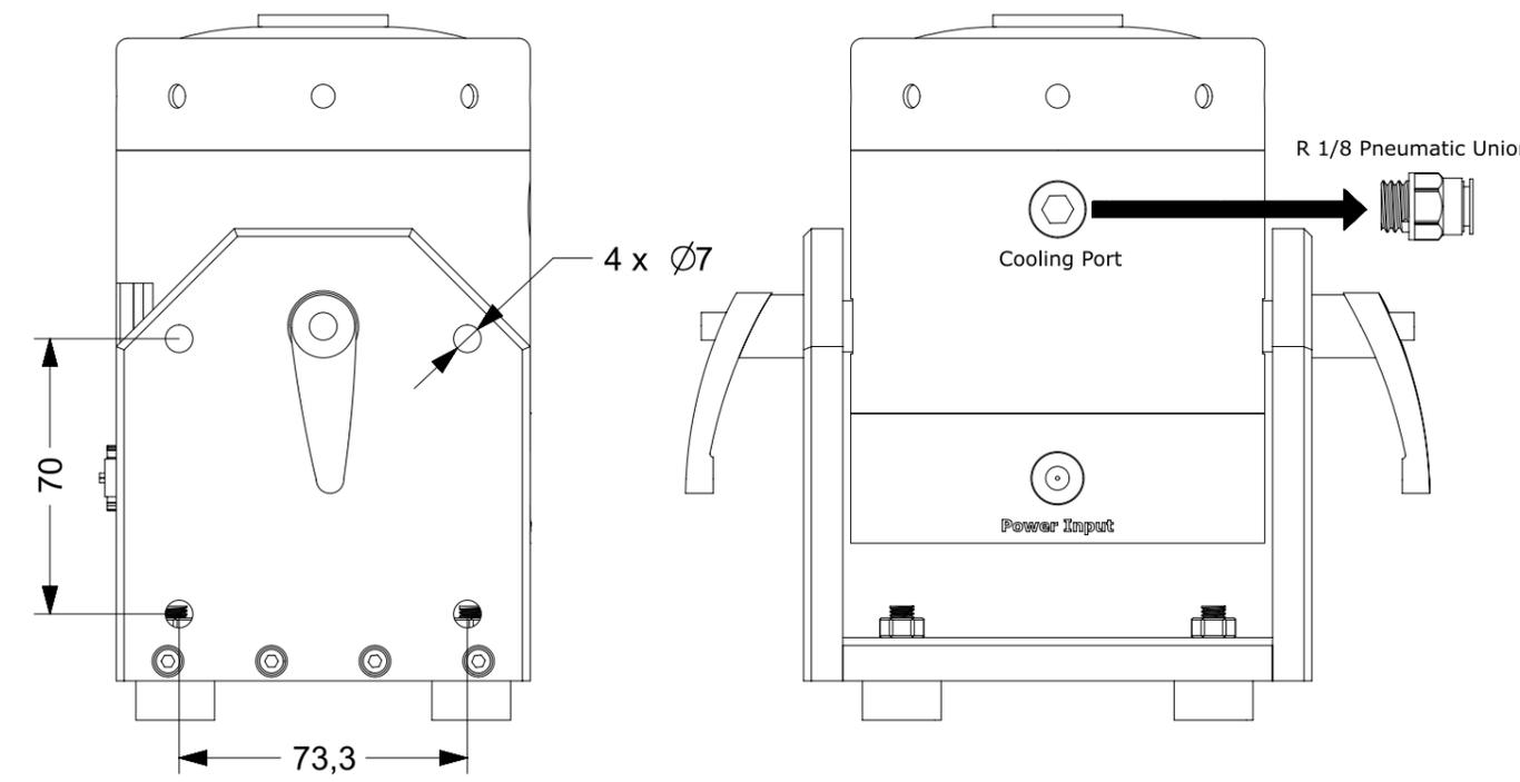
系统组成：电动振动器 + 电源适配器 + 信号电缆（BNC连接器- BNC连接器）+ R 1/8 气动接头 + M3 \* 10 不锈钢螺栓 + 用户手册
