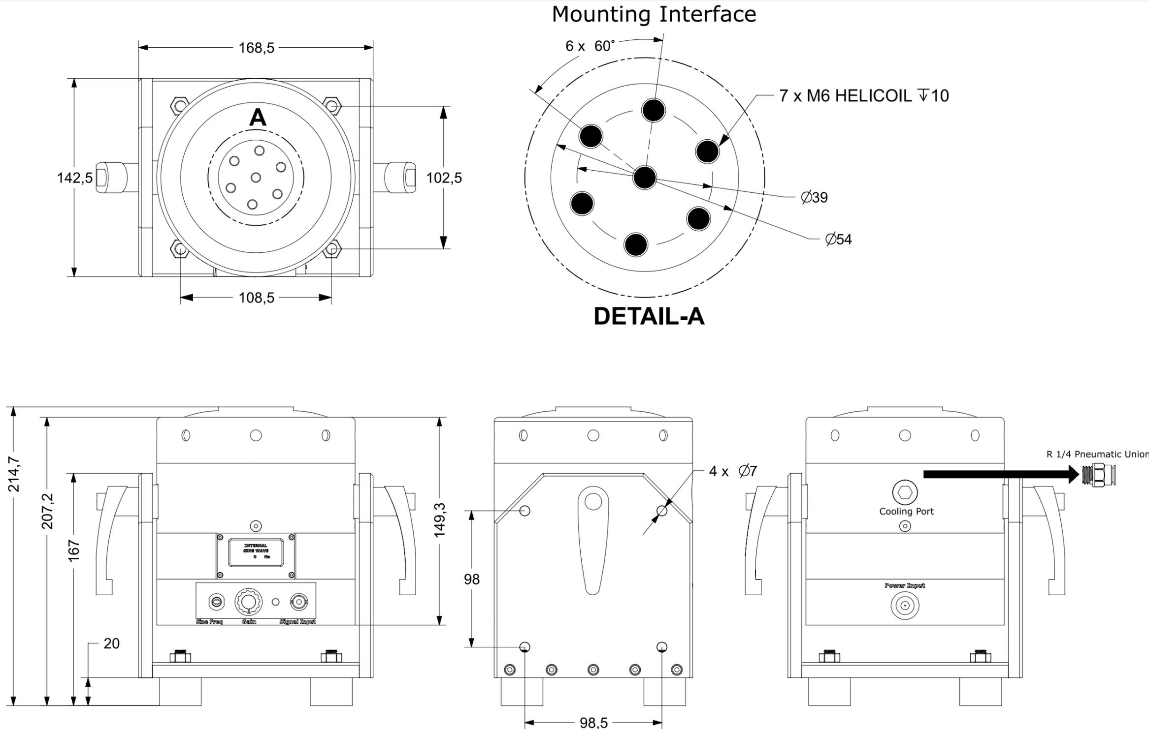
系统组成：电动振动器 + 电源适配器 + 信号电缆 (BNC连接器- BNC连接器) + R 1/4 气动接头 + M6 \* 10 不锈钢螺栓 + 用户手册
